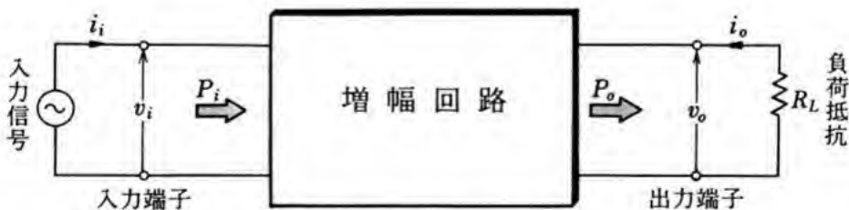
図 2-14 増幅回路の四端子表示
